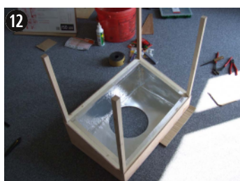
Isolation de la structure (laine de roche, liège et papier réfléchissant).
