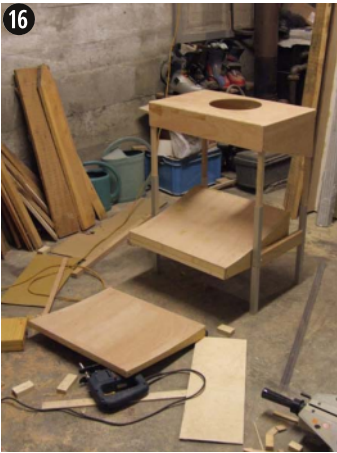
Réalisation et assemblage des réflecteurs.
