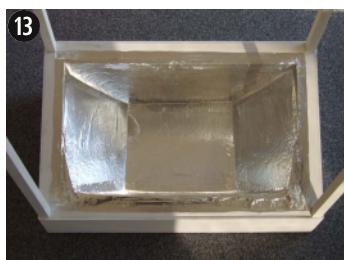
Ajout des panneaux à 45°, avant l'évidement circulaire.
