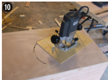
Réalisation de l'évidement circulaire pour la cocotte-minute.
